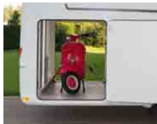
+ Soute décaissée avec rallonges de châssis rabaisées et renforcées - charge maximale 250 kg
