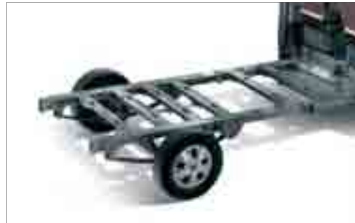
+ Châssis AL-KO rabaisé à voie large de série pour un confort de conduite avéré
