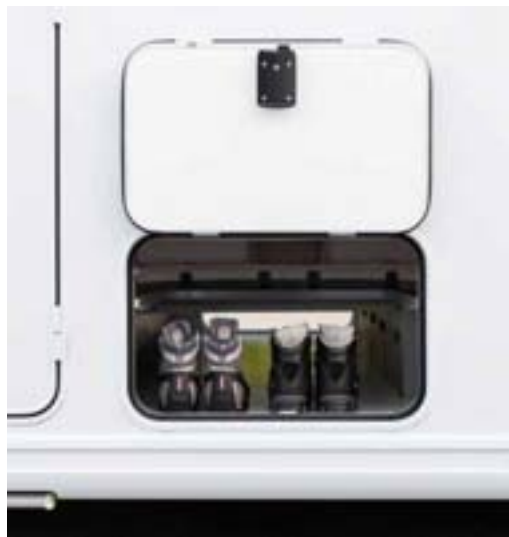
+ Double plancher traversant d'une hauteur de 300 mm (7)
