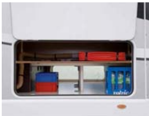
+ Protection contre le gel : double-plancher d'une hauteur de 40 cm
