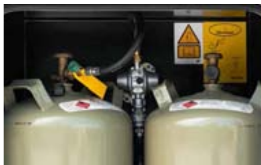
+ Système permettant l'utilisation du gaz en roulant « Crashsensor »
