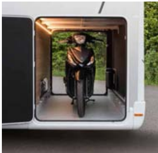
+ Soute décaissée avec rallonges de châssis rabaisées et renforcées, permettant une charge maximale de 250 kg
