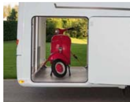
+ Soute décaissée avec rallonges de châssis rabaisées et renforcées, permettant une charge maximale de 250 kg
