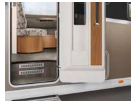
+ Porte cellule extra-large (70 cm) avec assistance électrique à la fermeture
