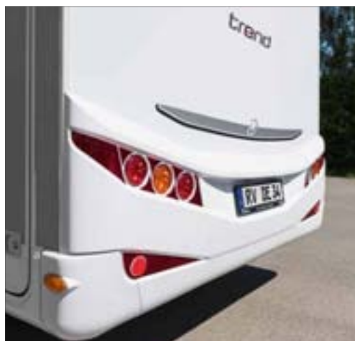
+ Face arrière en plusieurs parties pour simplifier les éventuelles réparations
