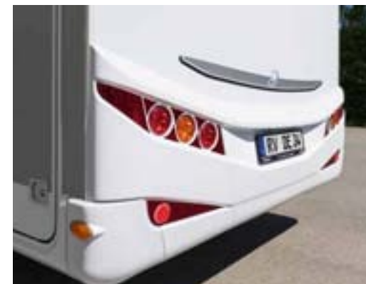
+ Face arrière en plusieurs parties pour simplifier les éventuelles réparations
