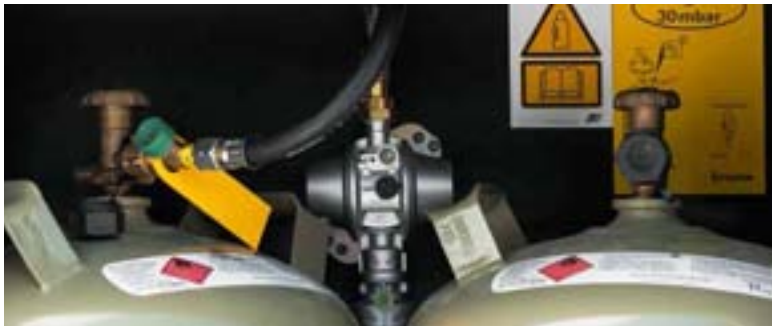
+ Crashsensor Tous nos véhicules sont équipés de série d'un détendeur qui grâce au détecteur de choc intégré, permet de chauffer le véhicule au gaz, en toute sécurité pendant les trajets.
