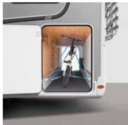
+ Rallonges de châssis rabaisées (selon implantation), offrant une grande soute haute et volumineuse
