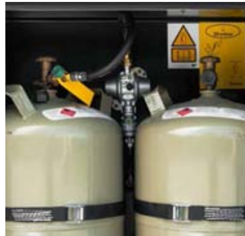
+ Système permettant l'utilisation du gaz en roulant « Crashsensor »
