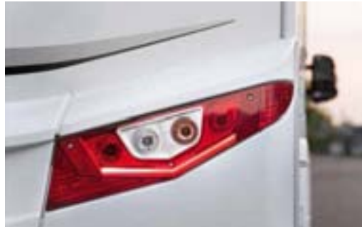
+ Feux arrière type automobile avec bandeau lumineux à LED
