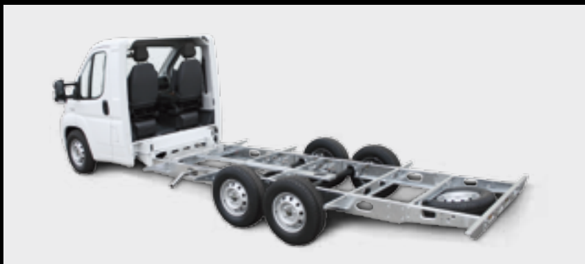
Châssis AL-KO rabaissé double essieux (3)
