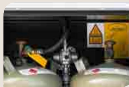
► Système permettant l'utilisation du gaz en roulant « Crashsensor »
