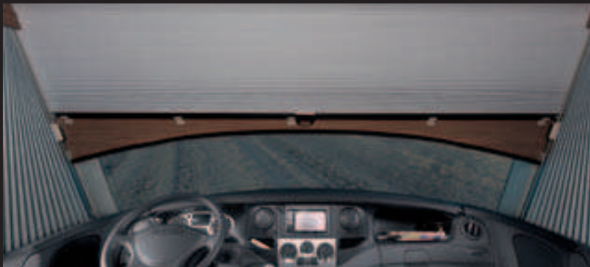
Obturateur vertical de pare-brise
