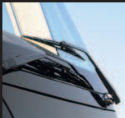
Système d'essuie-glace opposé et robuste
