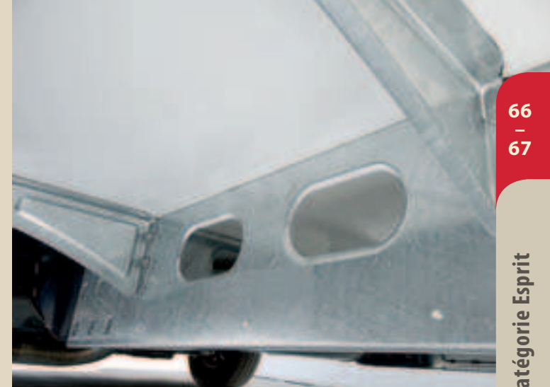
► Plancher sans tasseaux bois et habillé de panneaux en polyester
