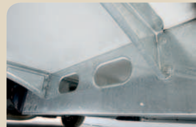
► Plancher sans tasseaux bois et habillé de panneaux en polyester
