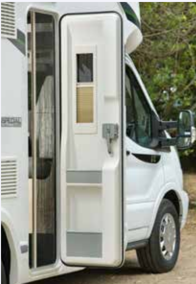
Porte cellule avec baie/moustiquaire.
