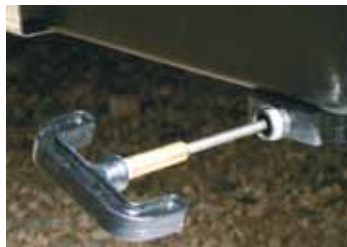
La vidange des eaux usées se fait sans se salir, en actionnant simplement la tirette latérale !
