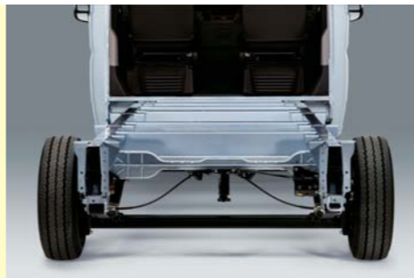
Voie arrière élargie.
