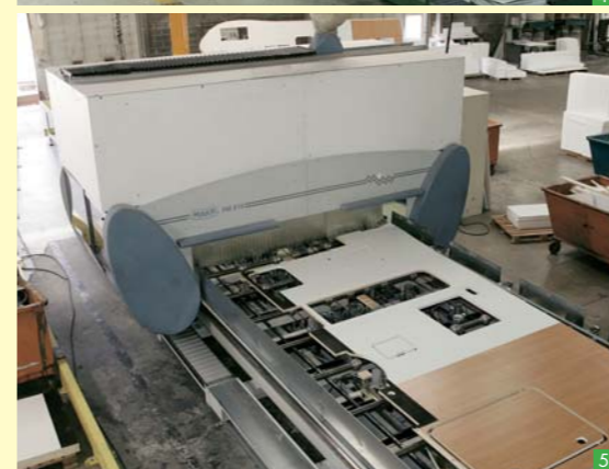
4/5 - Le centre d'usinage numérique pour la fabrication des panneaux de carrosserie, la technologie Chausson dédiée à une idée très précise de ce que doit être votre bonheur...
