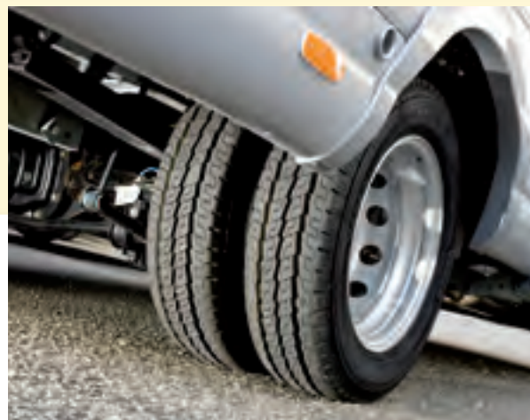
Roues arrière jumelées sur Ford châssis cabine*, capacité de charge et poids tractable optimisés
