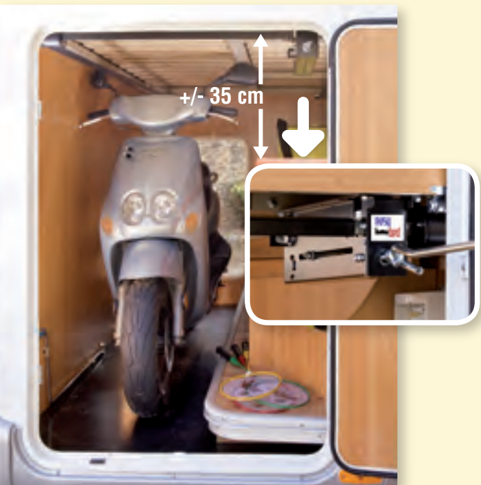
Système EASY BED : réglages manuels de la hauteur du lit (amplitude 35 cm) sur Genesis 31/Genesis 34
