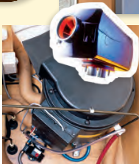
La chaleur ambiante est assurée grâce à un chauffage à air pulsé utilisant le carburant du véhicule ou le gaz*.
