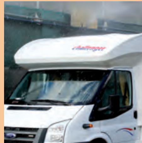
Simulateur recréant les conditions de roulage ou de stationnement sous la pluie, permettant d'effectuer des tests intensifs d'étanchéité
