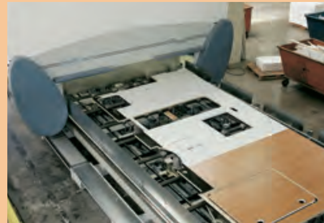
Centre d'usinage numérique pour la fabrication des panneaux de carrosserie
