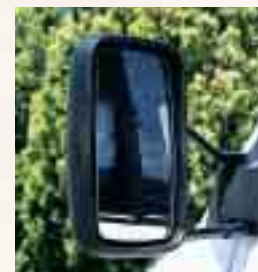
Rétroviseurs extérieurs grande largeur, dégivrables et réglables électriquement.
