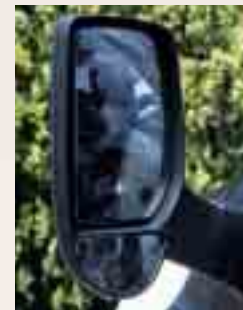
Rétroviseurs extérieurs grande largeur, dégivrables et réglables électriquement. Verrouillage centralisé des portes de la cabine avec commande à distance.
