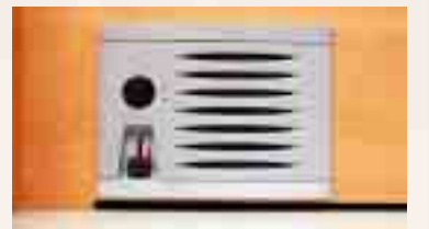
Chauffage de route additionnel couplé à celui du châssis de base pour le confort des passagers.
