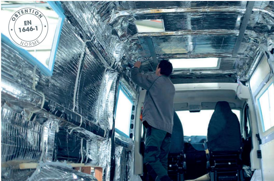
Isolation XHP complète parois intérieures, plafond et pavillon des véhicules à base de polyuréthane et polyéther
