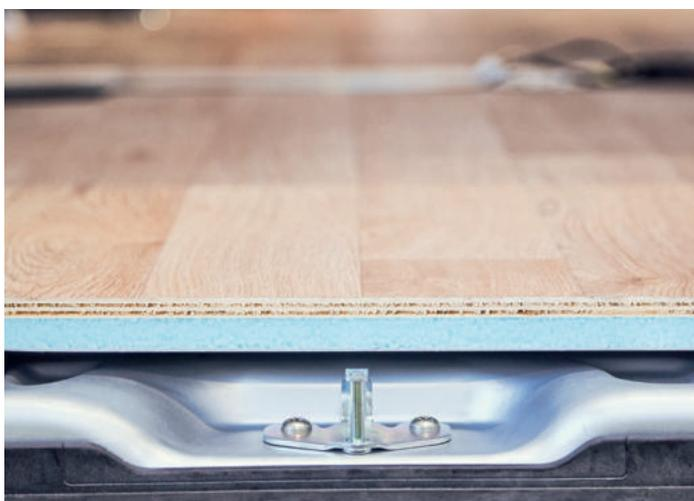
Plancher 25 mm avec isolation Styrofoam et soubassement polyester
