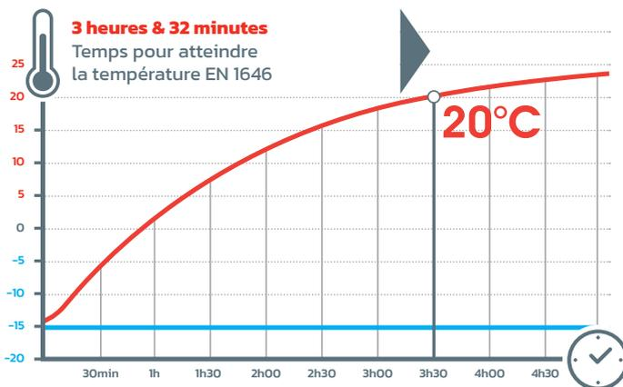
Des tests en chambre froide par  $-15^{\circ}\text{C}$  ont permis d'établir que les fourgons aménagés de notre marque atteignent les normes d'isolation des camping-cars tout en supprimant au maximum les ponts thermiques.
