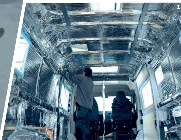
Test isolation & chauffage Campérêve RM Type Magellan selon la norme EN 1646-1 avec un Truma Combi 4 par -15^{\circ}\text{C}
