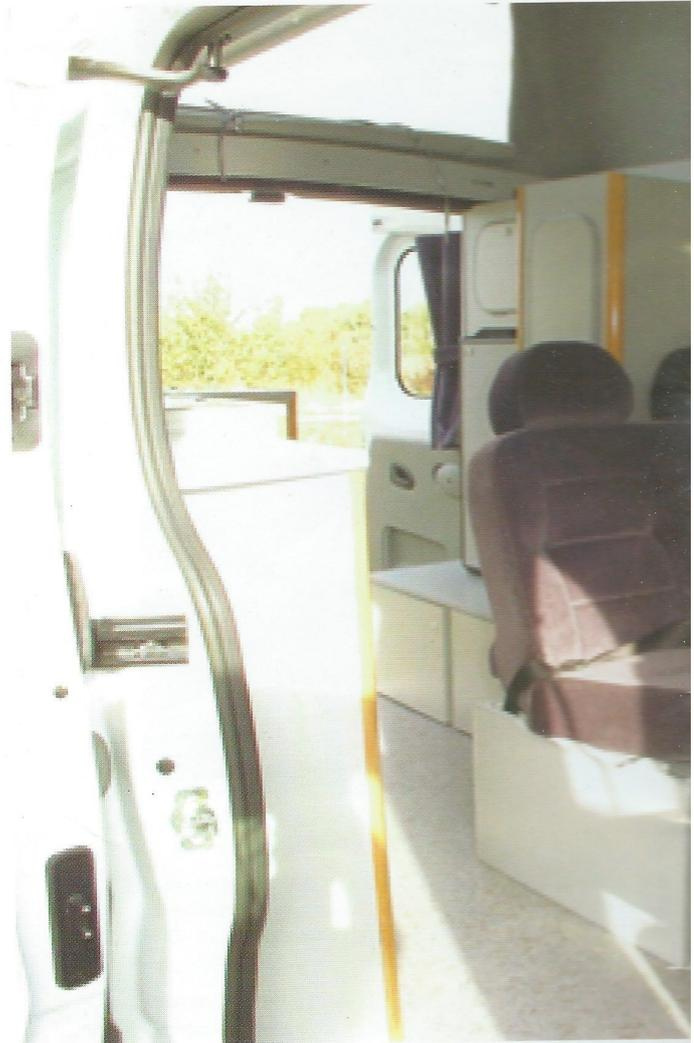
Mêmes dimensions que le Mirande, construit aussi sur le Renault Trafic long, semi-vitré ; deux grandes baies d'origine, teintées, coulissantes (derrière le chauffeur et sur la porte latérale).
