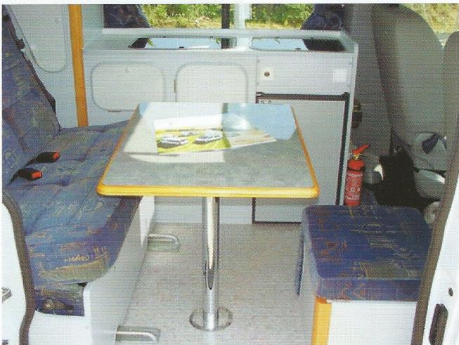
Implantation banquette et soute à bagages arrière, pour ce quatre places route. Ceintures trois points à enrrouleur et appuis-tête amovibles ; les glissières permettent aux passagers de se rapprocher du poste de conduite pour une communication plus agréable.
