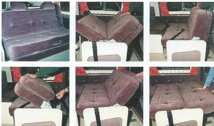
La banquette face route. La manette de déblocage permet de renverser la banquette dos à la route. Les glissières au sol permettent le déplacement avant/arrière.
