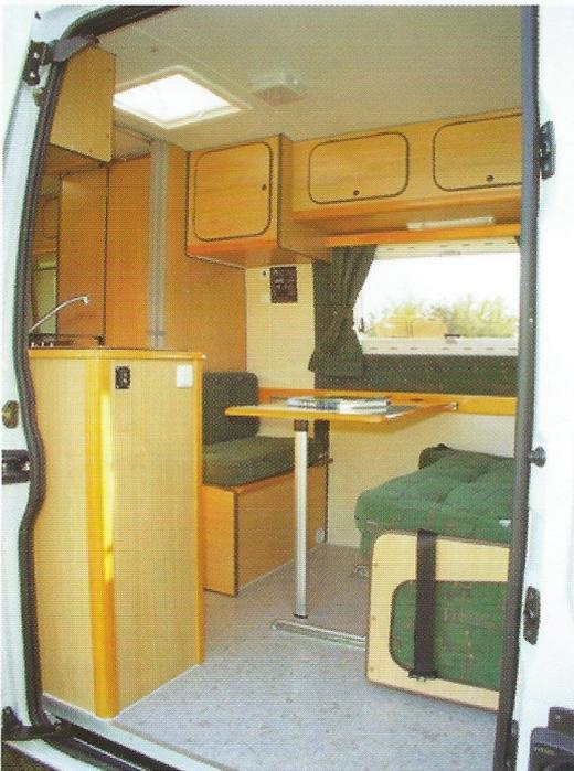
La dînette latérale se fait derrière le poste de conduite, sans encombrer la cuisine, ni l'accès au cabinet de toilette et à la " chambre ". La banquette se retourne rapidement vers la table face à la banquette/coffre arrière, assise extensible si nécessaire.
