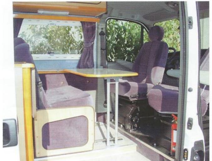
Quatre places route ; les passagers voyagent confortablement sur la banquette réversible, équipée de ceintures de sécurité trois points à enrouleur et d'appuis-tête. Les deux sièges de cabine sont pivotants pour le coin repas (les housses de sièges sont une option).
