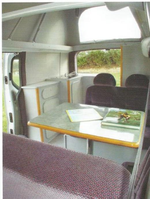
Sur le côté droit, le bloc-cuisine en L, est équipé d'un réchaud deux feux et d'un évier affleurants avec couvercles, d'une douchette : le gaz y est stocké, accessible par la porte arrière ; beau plan de travail près de la porte latérale ; divers rangements dont un tiroir. Les deux réservoirs sont sous le châssis.
