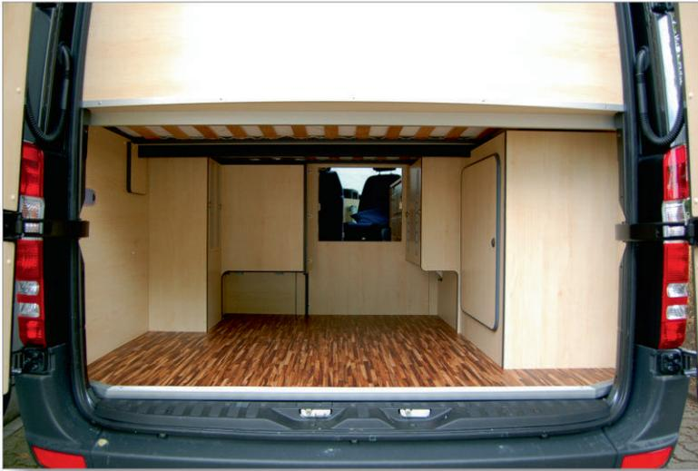
Le mobilier est construit à partir de panneaux contreplaqués de 15 mm recouverts de film mélaminé d'environ 0,6 mm (placage massif en option). Pour davantage de solidité et donc longévité, les arêtes horizontales et verticales sont toutes en bois massif.
