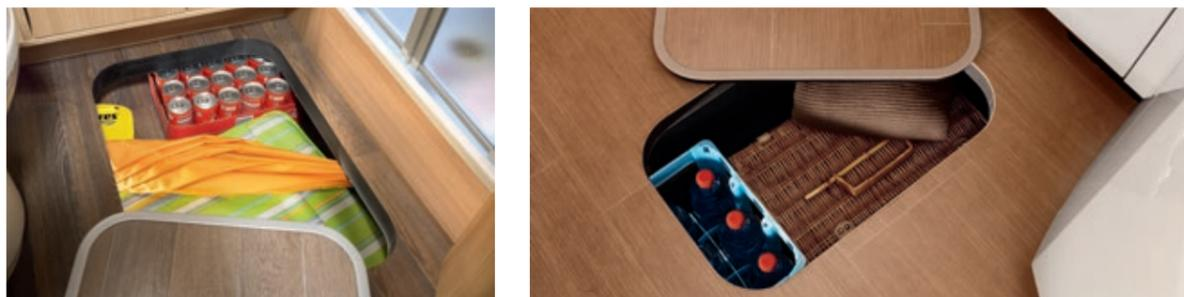
Le double-plancher isolé et chauffé offre également de la place pour stocker vivres et objets personnels tout en les protégeant du froid (sur Lyseo TD Classic et Privilège, Ixeo T, Ixeo I)
