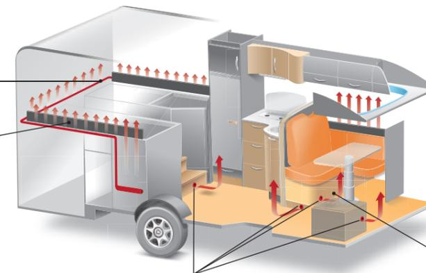
Réseau de gaines et de bouches d'aération pour une répartition optimale de la chaleur
