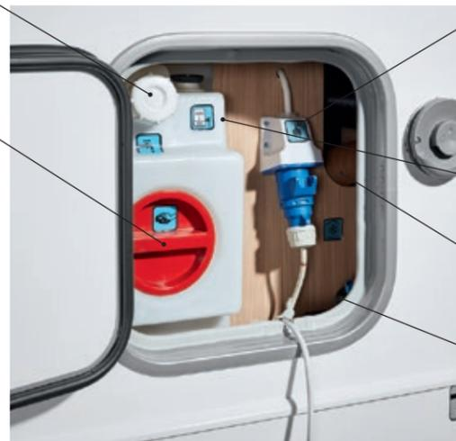
Remplissage du réservoir d'eau
