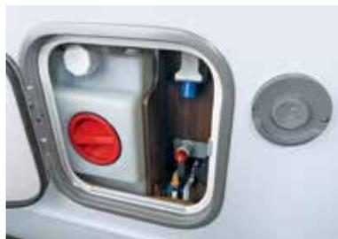
**Service Unit.** Local extérieur chauffé regroupant le remplissage d'eau, le regard de visite de la cuve d'eau, le branchement 230V, la valve de sécurité du chauffage-chauffe-eau.
