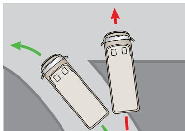
**ABS** : En cas de freinage, les roues ne se bloquent pas et la trajectoire est contrôlée.
