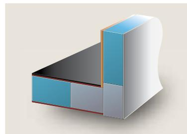
**Optimale :** Construction sans ossature-bois avec isolation XPS (Travel Van et Nexxo).
