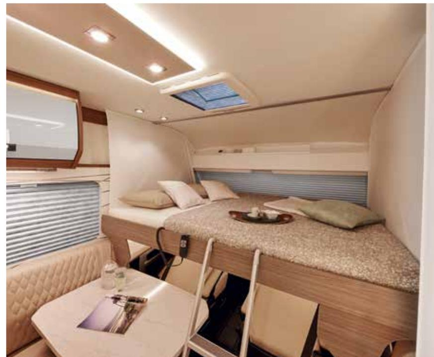
**Deuxième chambre.** La chambre haute offre une qualité de couchage presque équivalente à celle d'un lit fixe, grâce à son matelas en mousse coulée à froid 5 zones et à son sommier à lattes. Parfaitement intégré sous le plafond, le lit peut être positionné automatiquement grâce à un moteur électrique (option). Le store plissé en cabine permet d'obscurcir l'habitacle et de créer une ambiance propice au repos. Le fin du fin.
