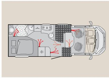
**Parfaitement chauffé.** Les Ixeo Time et Ixeo bénéficient des services d'un combiné Truma Combi 4 assurant un agréable chauffage par air pulsé.
