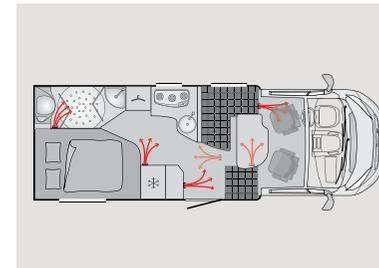
Le positionnement du chauffage garantit **une répartition optimale de l'air chaud** à l'intérieur.
