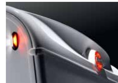
**Spoiler de toit.** A l'arrière, le 3e feu stop obligatoire est astucieusement enchâssé dans un spoiler de finition (Travel Van et Nexxo).
