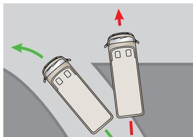
**ABS.** Technologie de pointe pour plus de sécurité : en cas de freinage, surtout brutal, l'ABS (sur tous nos modèles) évite le blocage des roues et, donc, limite le risque de perte d'adhérence.
