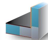
Construction sans ossature bois avec isolant XPS
