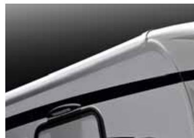
**Belle finition.** Le toit vient à recouvrement sur les flancs grâce à une forme arrondie (Nexxo).
