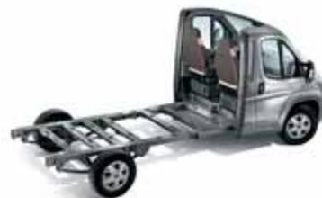
**Châssis camping-car.** Élaboré spécifiquement pour le camping-car, ce châssis Fiat Ducato est plus léger (charge utile) et plus bas (centre de gravité abaissé) que celui de l'utilitaire.
