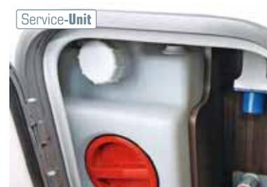
**Service Unit.** Local extérieur chauffé regroupant le remplissage d'eau, le regard de visite de la cuve d'eau, le branchement 230V, la valve de sécurité du chauffage-chauffe-eau. Très pratique (Ixeo Time).
