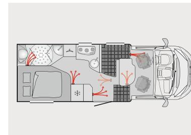
**Parfaitement chauffé.** Les Brevio bénéficient des services d'un combiné Truma Combi 4 idéalement placé pour dispenser un agréable chauffage par air pulsé.
