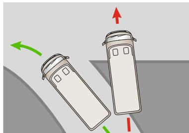
**ABS / ESP.** Deux technologies pour plus de sécurité : en cas de freinage, l'ABS (de série) évite le blocage des roues. L'ESP (option) permet de corriger et de contrôler la trajectoire.
