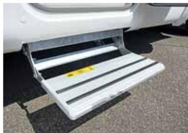
**Complément utile.** Un marchepied électrique facilite les entrées et sorties du Brevio. Descendant bas vers la chaussée, il aide à sécuriser ces opérations.
