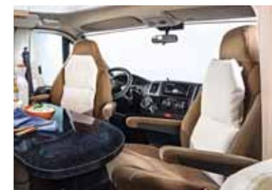
**Sièges conducteur et passager.** Houssés de série dans le tissu choisi pour l'habitacle. Sièges pivotants, réglables en hauteur (Nexxo).
