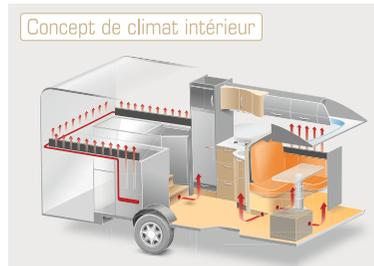
**Chaleur équilibrée.** L'appareil de chauffage est installé de manière à assurer une répartition harmonieuse de l'air chaud pulsé.
