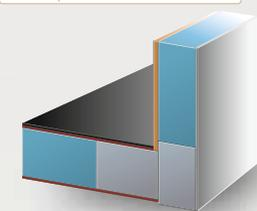
**Sans bois.** Plus aucun pont thermique, car plus d'ossature bois ! Et plus aucun risque de rétention d'eau.
