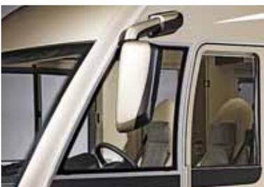
**Façon bus.** Grâce à ces rétroviseurs électriques suspendus à double miroir, la rétrovision est améliorée.
