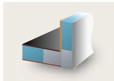
**Optimale :** Construction sans ossature-bois avec isolation XPS (Nexxo).
