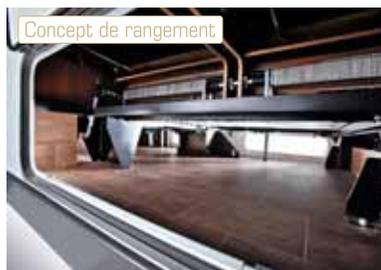
**Double-plancher Bürstner.** Les Élégance et les Grand Panorama ont un atout supplémentaire : un double plancher technique chauffé recevant notamment les réservoirs.
