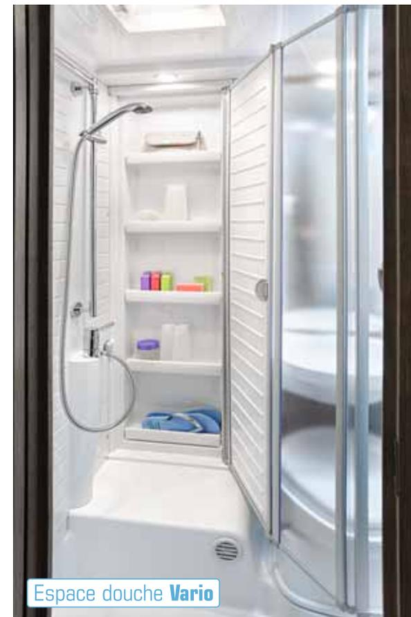
**Douche XL.** Le concept, avec l'espace Vario, est de pouvoir métamorphoser la salle d'eau en une confortable cabine de douche. Comme le montrent bien nos photos, l'opération s'effectue en un clin d'œil : on fait pivoter le lavabo au-dessus des wc, on les protège à l'aide d'une paroi anti projections et c'est tout !
