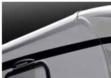
**Belle finition.** Le toit vient à recouvrement sur les flancs grâce à une forme arrondie.
