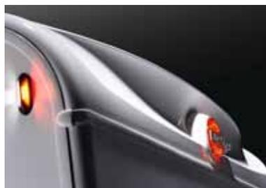
**Spoiler de toit.** A l'arrière, le 3e feu stop obligatoire est astucieusement enchâssé dans un spoiler de finition (Nexxo).
