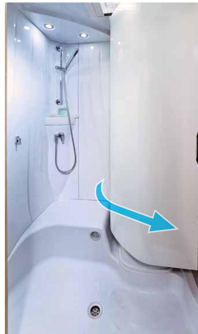
**Espace douche Vario.** A priori, un simple cabinet de toilette. En réalité, une vraie salle d'eau avec douche séparée, obtenue grâce à un dispositif faisant disparaître le bloc lavabo le temps de la douche. Difficile d'imaginer plus ingénieux. En tout cas, économe en surface au plancher et pourtant très pratique à l'usage.
