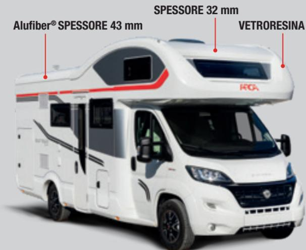
**La mansarda** Europa è formata da un tetto in pannello sandwich in vetroresina esterna dallo spessore di 32 mm che si unisce nella parte inferiore ad un piano strutturale estremamente resistente. Le pareti in Alufiber®, dallo spessore di 43 mm, assicurano un'eccellente coibentazione data dal materiale isolante PS estruso all'interno. Si aggiunge poi un guscio esterno in vetroresina per maggiore protezione, isolamento e solidità.
