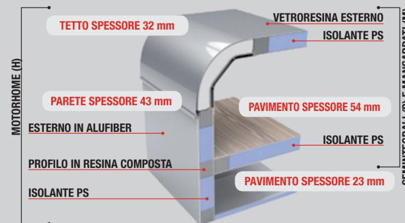
**Forti spessori: pavimento superiore 54 mm, pavimento inferiore 23 mm** (per motorhome). Grazie a questa struttura i gavoni Arca assicurano una maggiore portata di carico, **fino a 300 Kg di portata strutturale**, testata dinamicamente (peso tecnicamente caricabile che incide sui posti omologati o sul restante carico utile complessivo).
