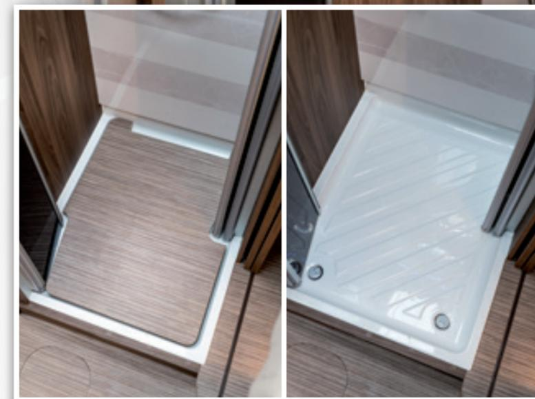
Ottime soluzioni per i box doccia, rivestiti da laminati con finiture ricche e stilose. Il piatto doccia, con doppia piletta di scarico, è realizzato tramite una termoformatura in ABS rinforzato con schiuma in poliuretano ad alta densità a garanzia di rigidità e resistenza a crepe e deformazioni nel tempo. La pedana doccia ti permette di muoverti facilmente su un pavimento lineare e protegge gli ambienti dopo aver fatto la doccia. Il pomello doccia può essere posizionato a due diverse altezze.
