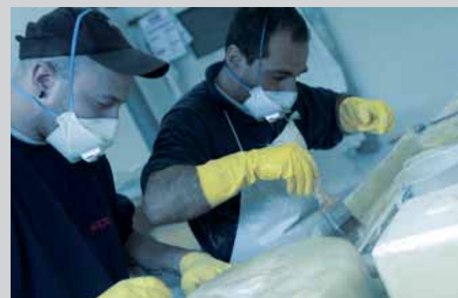
Fase del processo di realizzazione di un lavello cucina in vetroresina Arca
