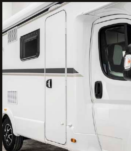
Nouvelle aile avant mieux isolée en construction sandwich.
