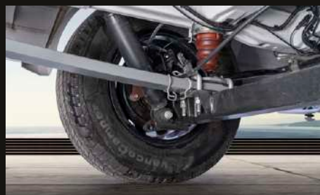
Ressorts à lames extrêmement légers fabriqués en plastique de haute technologie.
