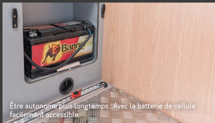
Le système électrique de bord est installé au-dessus du passage de roue pour gagner de la place.
