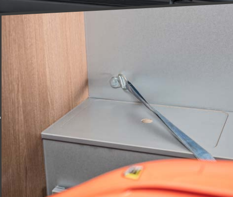
Il y a également des œillets d'arrimage sur la paroi latérale pour une sécurité absolue.
