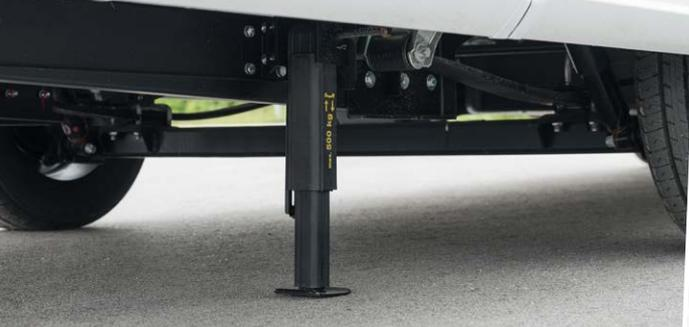
**Un verin à l'arrière.** Offre une stabilité supplémentaire et moins de vibrations lorsque le véhicule est à l'arrêt.
