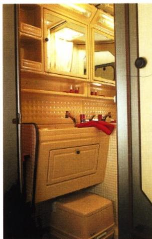
◀ Hier fühlen Sie sich wohl. Die elektrisch betriebene Wasserversorgung sorgt in Verbindung mit dem serienmäßig eingebauten Boiler für richtig temperiertes Wasser. Toilettenartikel finden im großzügig bemessenen Schrank ausreichend Platz. Unter dem Waschbecken befindet sich der Abstellplatz für die herausnehmbare Wasserspültoilette.
