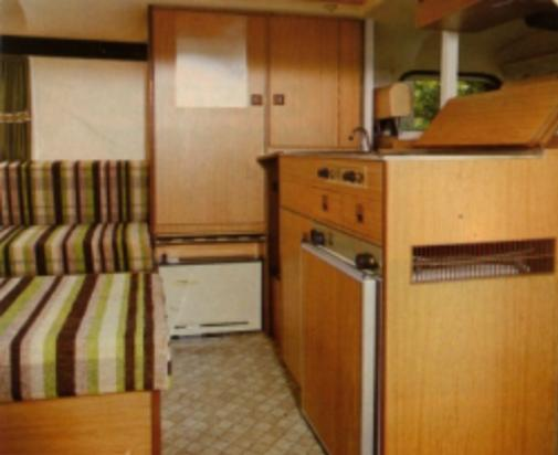
Kleider-/Wäscheschrank mit Spiegel, Gasheizung SDA 2000, rechts Küchenblock mit Nirostspüle, 2-Flammigem Gasherd und 60 l-Kühlschrank, 20 l-Wasserkarister und 5 kg-Gasflasche aufgestellt. Hängeschrank über Küche.
