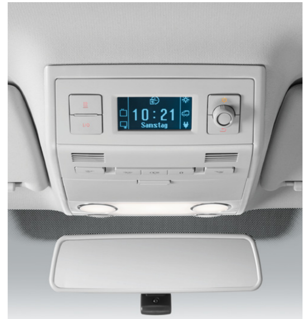
Le panneau de commande central. Placé au dessus du rétroviseur intérieur, il possède un écran à cristaux liquides indiquant la température extérieure, la charge des batteries, le branchement 230 V, le fonctionnement du réfrigérateur et le niveau des réservoirs d'eau potable et d'eaux usées. Le panneau de commande central intègre aussi la commande de chauffage stationnaire. Celui-ci fonctionne indépendamment du système de chauffage et de ventilation. Ses fonctions marche / arrêt peuvent aussi être actionnées par télécommande.
