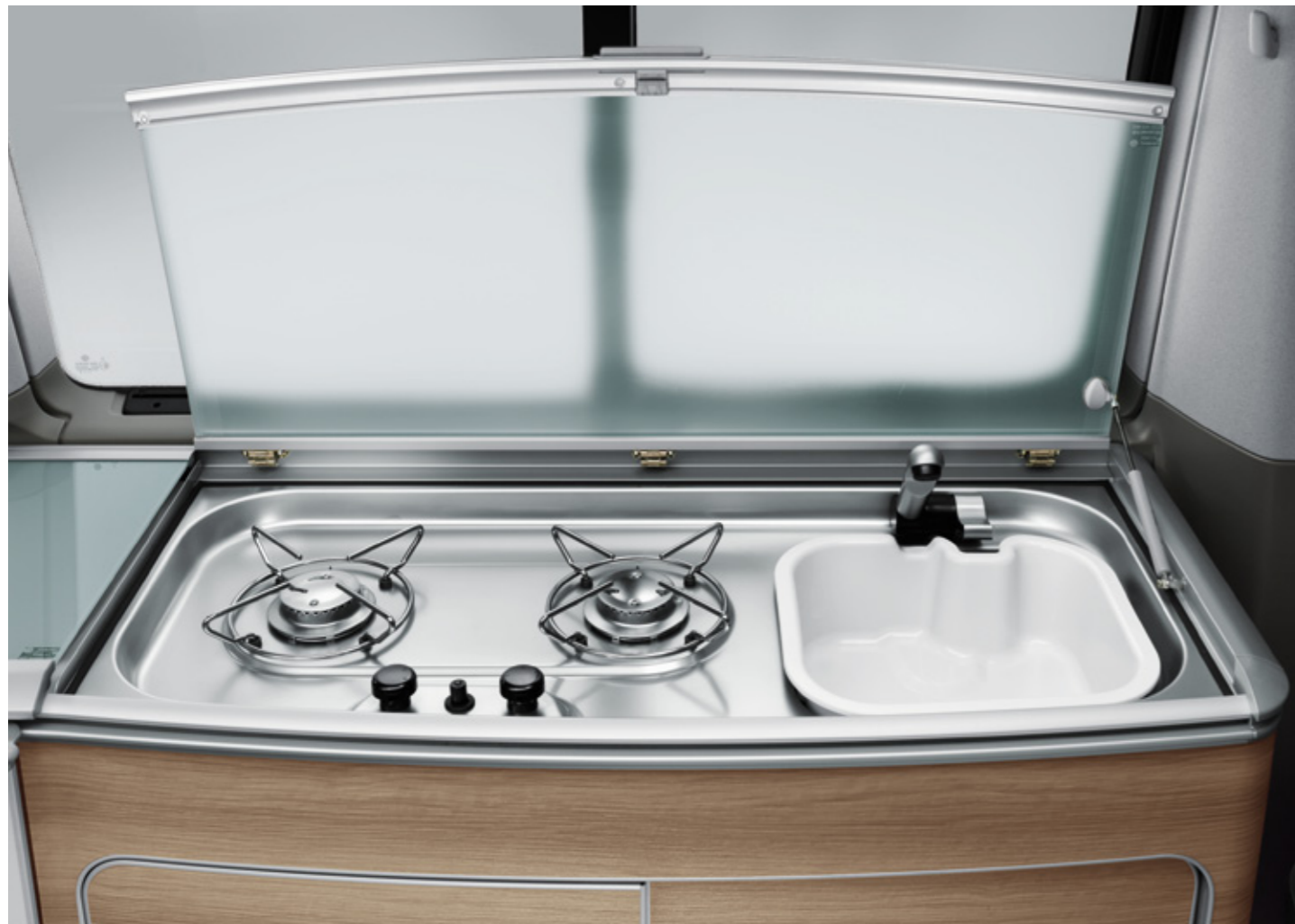
Le bloc évier / la table de cuisson. La table de cuisson gaz deux feux à allumage piézo-électrique est placée à gauche de l'évier inox. L'ensemble est muni d'une protection en verre. L'alimentation en eau est conforme à la directive DIN 2001-2.
