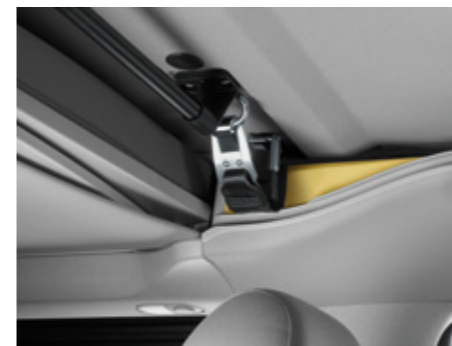
Le toit relevable à commande manuelle. Il se loge en toute sécurité dans son espace de rangement lors du voyage. Dès que vous êtes arrivé, il se relève en quelques gestes.
