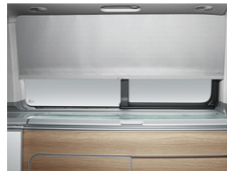
L'occultation de l'espace séjour. Elle est réalisée à l'aide de stores déroulants. Les guides latéraux intégrés aux montants des fenêtres assurent une parfaite occultation.
