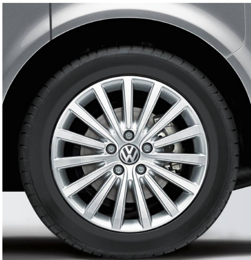
Quatre jantes alliage léger " Canberra " 8 J x 18. Avec pneus 255/45 R 18. Ces jantes alliage ne peuvent équiper la roue de secours.
