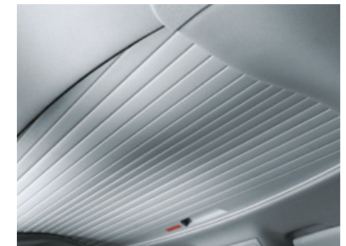
Le store à lamelles. Le haut de la cabine peut être fermé par un store à lamelles, en cas de non utilisation de la couchette.
