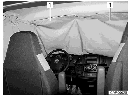
Fig. 22 Dispositif occultant de la cabine de conduite sur le pare-brise
