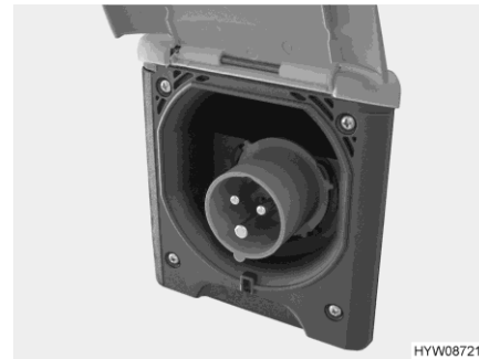
Fig. 75 Raccordement 230 V sur le véhicule (prise de courant CEE)
