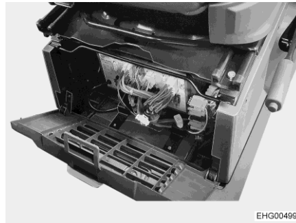
Fig. 71 Emplacement bloc électrique
