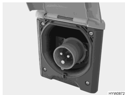
Fig. 98 Raccordement 230 V sur le véhicule (prise de courant CEE)
