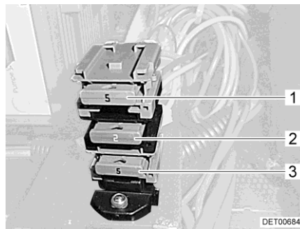
Fig. 104 Fusibles à côté du bloc électrique
