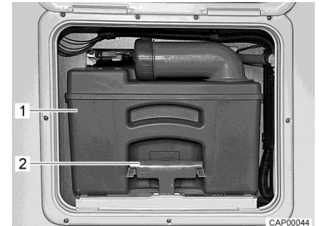
Fig. 150 Réservoir pour matières fécales
