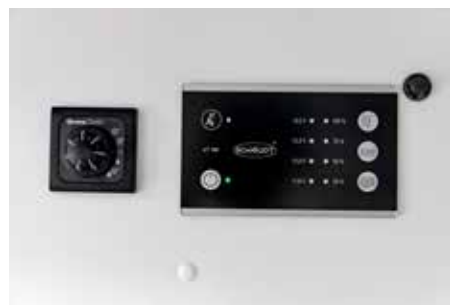
Panneau de contrôle avec indication des niveaux de remplissage et capacité de batterie
