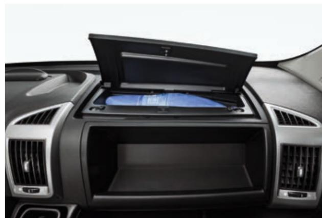
Compartiment réfrigéré intégré au tableau de bord
