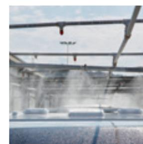
Test contre les infiltrations d'eau sur 100 % des véhicules sortis de la production, avant la livraison.
