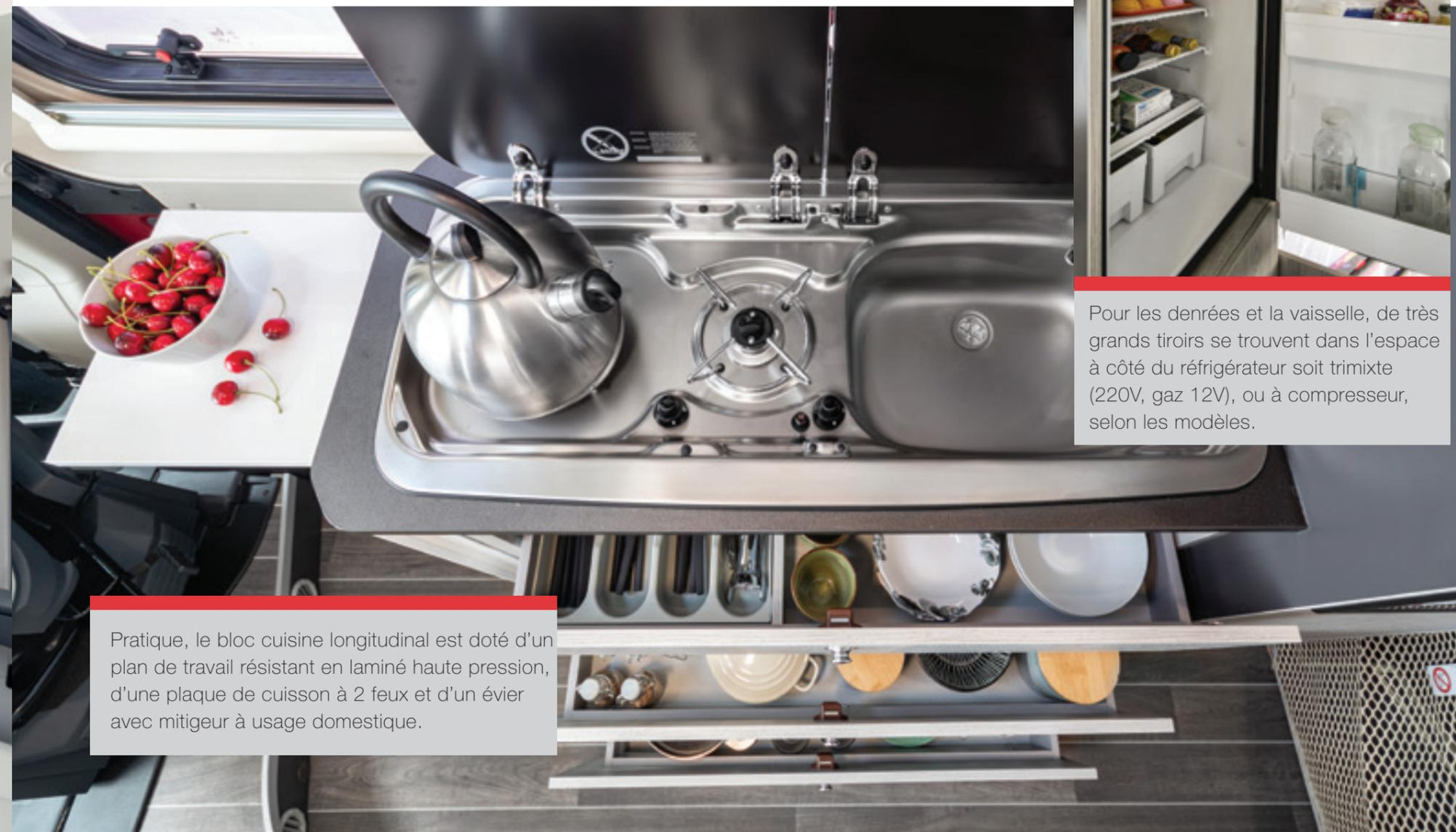
Pratique, le bloc cuisine longitudinal est doté d'un plan de travail résistant en laminé haute pression, d'une plaque de cuisson à 2 feux et d'un évier avec mitigeur à usage domestique.
