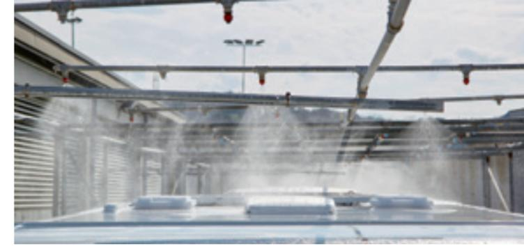
Test d'imperméabilité et d'infiltrations.
