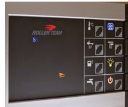
Centralina con display a cristalli liquidi e comandi a membrana Panneau de commandes avec affichage à cristaux liquides et commandes tactiles
