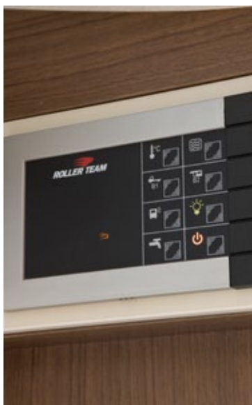
Centralina con display a cristalli liquidi e comandi a membrana Panneau de commandes avec affichage à cristaux liquides et commandes tactiles
