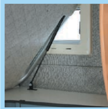
Bettrost im Alkoven anhebbar mit Gasdruckfeder (nur auf einigen Modellen) Overcab bed spring raised by piston mechanism (only for some models)
