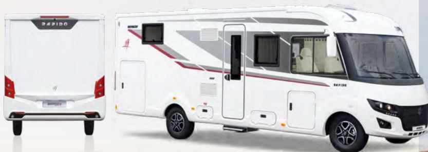
Le double plancher rangement traversant RAPIDO innove par son accessibilité extérieure ainsi que par les dimensions d'ouvertures qui permettent de ranger des chaises et une table pliantes. De plus, il bénéficie de tous les avantages d'un double plancher technique, comme l'isolation des eaux propres, qui profitent à l'aménagement intérieur en offrant de beaux volumes à vivre. La sensation d'espace est renforcée par le fait que le plancher soit plat sur toute la surface du véhicule.
