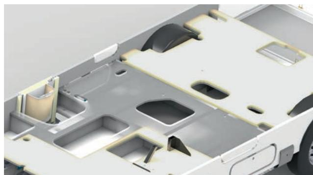
Le double plancher RAPIDO est solidaire du châssis abaissé AL-KO : son centre de gravité très bas assure une parfaite stabilité de conduite.
