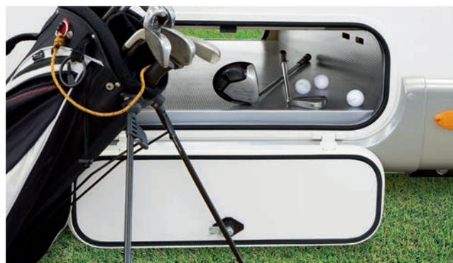
Double plancher rangement traversant accessible des deux côtés.
