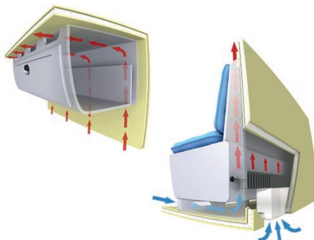
Schéma de principe de fonctionnement du chauffage ALDE. Ne correspond pas à la description précise du produit et/ou du mobilier.
