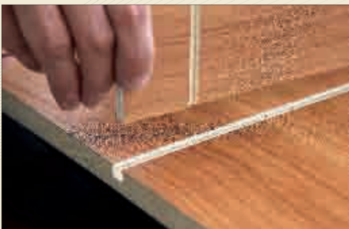
I mobili delle Serie 6 beneficiano di una tecnica di assemblaggio moderna e resistente, tra l'altro, ad incastro oppure tramite incollaggio o avvitatura, che permette l'assemblaggio perfetto delle pareti.
