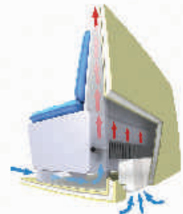
Schéma de principe de fonctionnement du chauffage ALDE. Ne correspond pas à la description précise du produit et/ou du mobilier.
