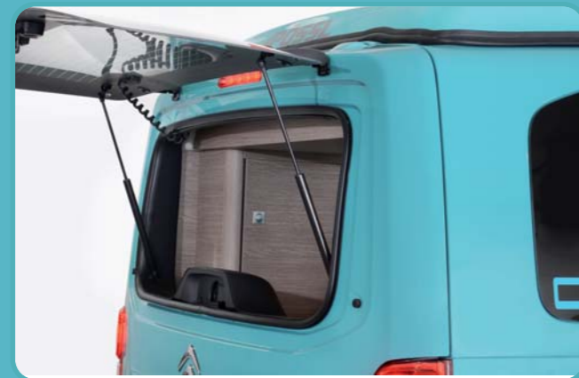
Geteilte Heckklappe für schnelles Beladen.
