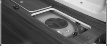
2 accès au réservoir d'eau propre Remplissage par l'extérieur avec 2 accès pour un entretien facile.
