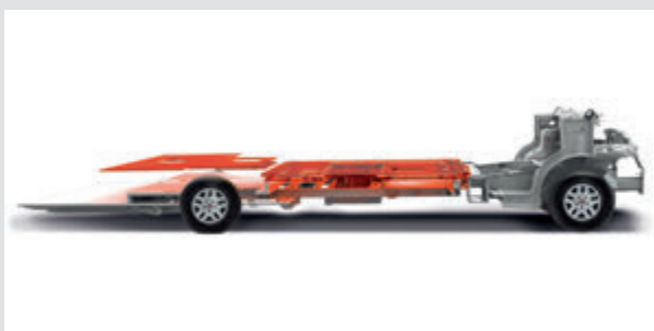
Hauteur de plancher 15 cm châssis FIAT®
