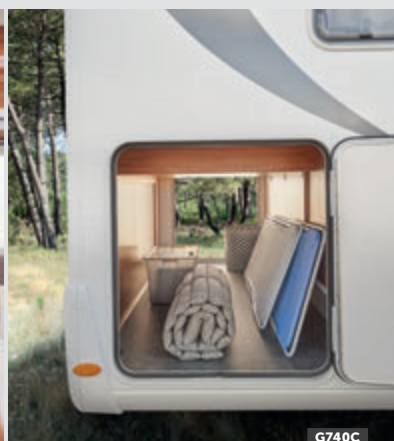
Soute isolée avec portillon à serrures à compression
