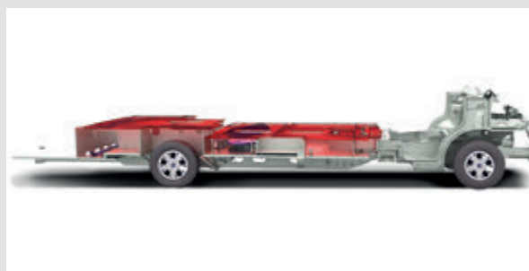
Hauteur de plancher 21 cm sur châssis AL-KO®
