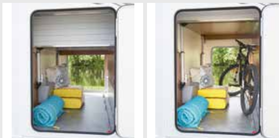
SOUTE RÉGLABLE ÉLECTRIQUEMENT EN HAUTEUR
