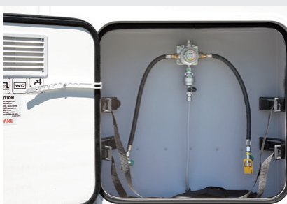
Coffre à Gaz 2 bouteilles 13kg avec détecteur de pression de gaz + capteurs de collision et Duo Control CS (inverseur de gaz automatique).
