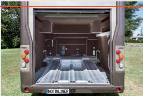
Garage voiture (Smart - Twizy) chauffé avec treuil de chargement
