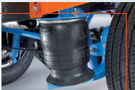
Suspensions VB Air entièrement pneumatique avant / arrière*
