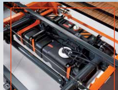
Réservoir de carburant 130L*
