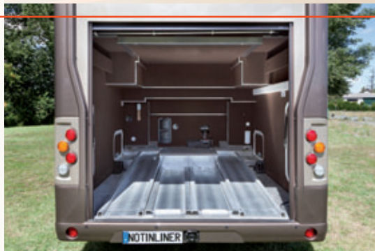
Garage voiture (Smart - Twizy - Toyota IQ) chauffé avec treuil de chargement
