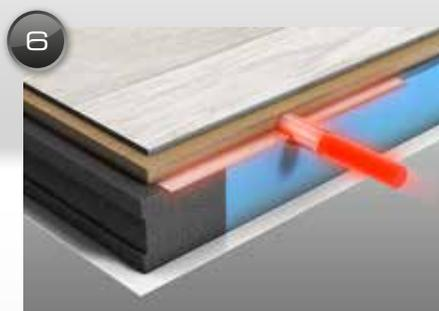
**Premium-Bodenaufbau:** Vollisolierter GFK-Unterboden, Wohnraumboden aus GFK, Sperrholz und PVC.
