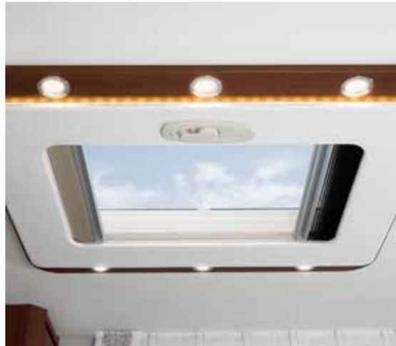
□ **Panorama-Dachluke** harmonisch in das Umfeld des LED-Mittelbaldachins eingepasst. Inklusive integriertem Insektenschutz und Verdunklungsmöglichkeit.
