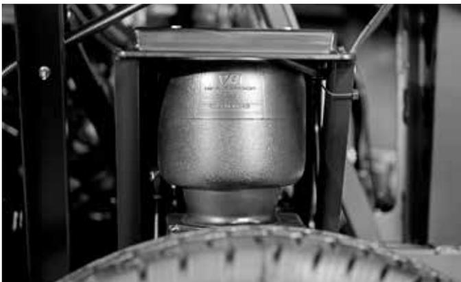
□ **VB Airsuspension Luftfederung** für die Hinterachse oder für Vorder- und Hinterachse mit Funktion „Heben und Senken“, serienmäßig oder als optionale Sonderausstattung. Sie stabilisiert das Fahrzeug nach aktueller Belastungssituation, ein gleichbleibend gutes Fahrverhalten wird erreicht. Die Seitenwindempfindlichkeit wird deutlich reduziert. Diverse Sonderfunktionen erweitern das Anwendungsspektrum der Luftfederung.
