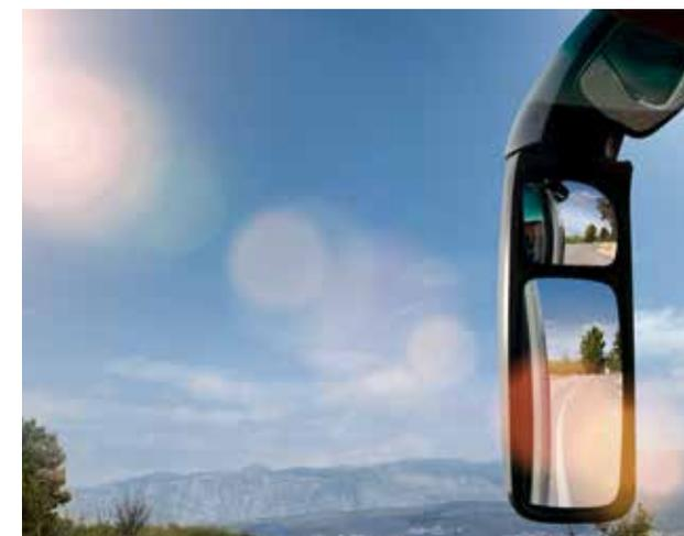
■ **Omnibus-Außenspiegel** mit integrierten Weitwinkelspiegeln bieten beste Sicht nach hinten. Zwei Bugspiegel ermöglichen den direkten Blick vor das Fahrzeug und erleichtern das Einparken.
