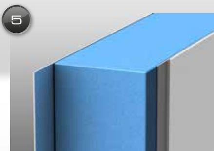
**Premium-Wandaufbau:** Sandwich-Bauweise mit extrem widerstandsfähigen Aluminiumblechen außen.
