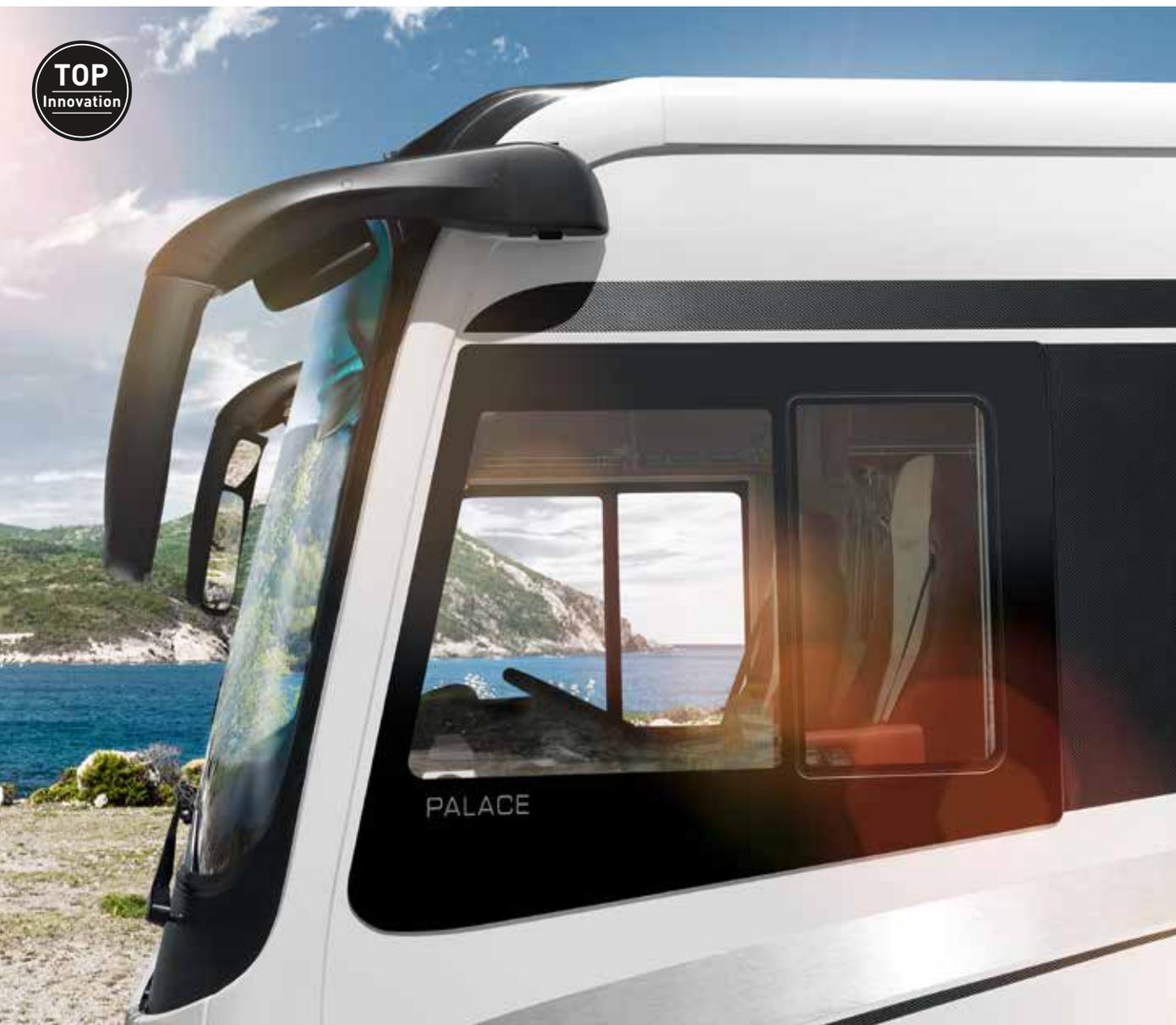
□ **Elektrisches Cockpit-Seitenfenster** stufenlos steuerbar mit Isolier-Doppelverglasung. Elegantes Design, da absolut bündig mit den großflächigen Cockpit-Seitenscheiben.
