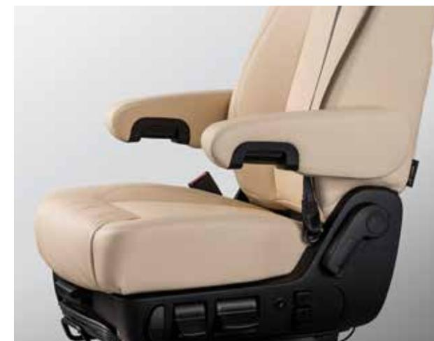
□ **Fahrerhaussitz Luxus** als Sonderausstattung multifunktional verstellbar und luftgefedert. Mit Sitzheizung, verstärktem Sitz und Rücken sowie 2-fach Lendenwirbelstütze.
