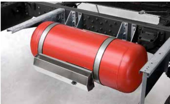
□ **Gastank** Nahezu alle MORELO Reisemobile können mit einem 120 Liter Gastank ausgerüstet werden. 120 Liter entsprechen in etwa 48 Kilogramm Flüssiggas und ersetzen damit 4,5 Gasflaschen. Mit einem so ausgerüsteten Reisemobil können extrem lange Standzeiten gewährleistet werden, ein großer Vorteil gerade im Winter. Bei den größeren MORELO Reisemobilen ist sogar die Ausrüstung mit einem 200 Liter Gastank möglich.
