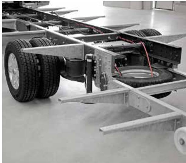
■ **Stabiler Leiterraum** als Basis des Fahrwerks mit massiven Seitenauslegern für den Aufbau der Reisemobile. Die tiefe Ladekante erleichtert das Beladen des Heckraumes.
