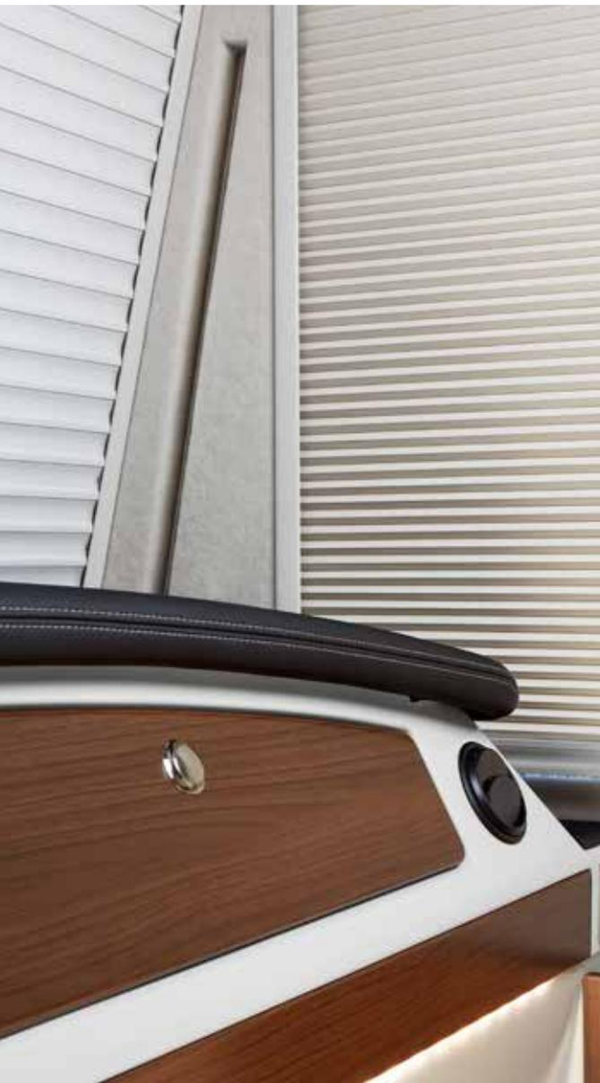
■ **Fahrerhaus Isolier- und Verdunklungskonzept** mit hervorragender Wärme- und Schalldämmung sowie elektrisch bedienbarem Isolier- und Verdunklungsrollo für die Windschutzscheibe.
