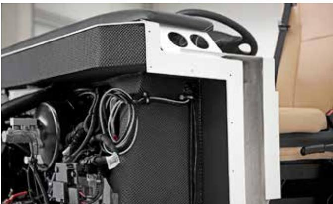
■ **GFK-Frontmodul** für Luxusreisemobile, von Fahrzeugbau Meier für MORELO weiter optimiert. Es dient als Abschluss des Innenraumes nach vorne und als tragender Unterbau für das eigenständige MORELO-Armaturenbrett. Zu den überragenden Vorteilen zählen eine perfekte Isolation, die stabile Anbindung der Seitenwände, eine außer-ordentlich hohe Schalldämmung und absolute Verrottungsfreiheit.
