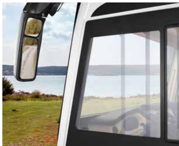
□ **Fahrerhaus-Fenster elektrisch** per Taster stufenlos in jede Position fahrbar. Absolut bündig mit den großflächigen Seitenscheiben des Cockpits, daher reduzierte Windgeräusche.
