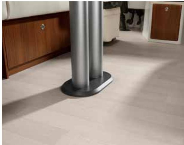
■ **Ebener Wohnraumboden** durchgängig vom Schlafraum bis in den Fußraum des Cockpits ohne Stoßfuge. Wohlige Wärme durch Fußbodenheizung bis ins Cockpit.
