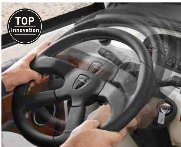
□ **Lederlenkrad abnehmbar** zum bequemen Drehen des Fahrersitzes und komfortabler Neigung der Rückenlehne bei Einbeziehung in die Sitzgruppe – mit Schnellverschluss.
