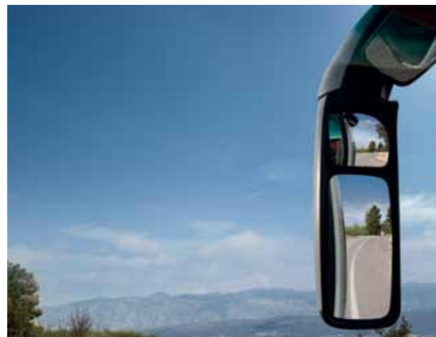
■ Les rétroviseurs extérieurs d'autobus à grand angle intégré offrent une meilleure vue à l'arrière. Les deux rétroviseurs à l'avant permettent d'entrevoir directement ce qui se passe devant le véhicule et facilitent le stationnement.
