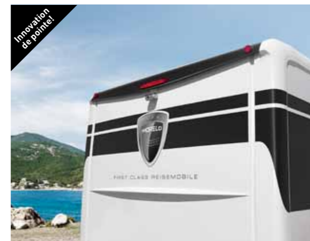
■ L'aileton arrière sert d'arête de décollement de la couche limite et réduit l'encrassement du panneau arrière. Le profil du toit conduit l'eau à l'arrière et à l'avant et évite ainsi que les parois latérales ne se salissent.
