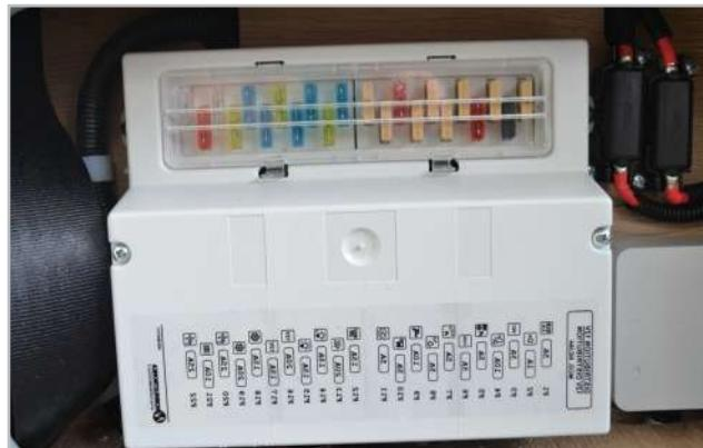
Fig. 7.3 - Porte-fusibles C/Poliswitch
