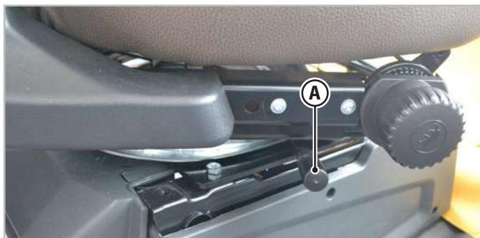
Fig. 3.3 - Rotation du siège
