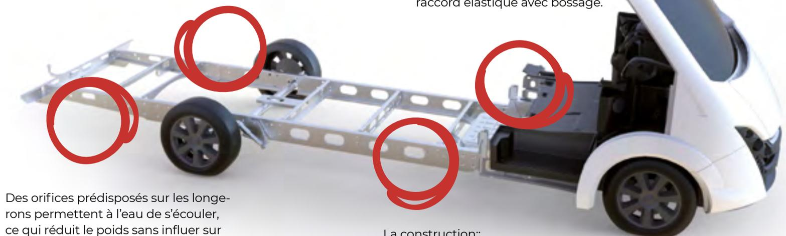
Des orifices prédisposés sur les longérons permettent à l'eau de s'écouler, ce qui réduit le poids sans influencer sur la solidité. L'utilisation d'acier haute résistance garantit une stabilité remarquable.
