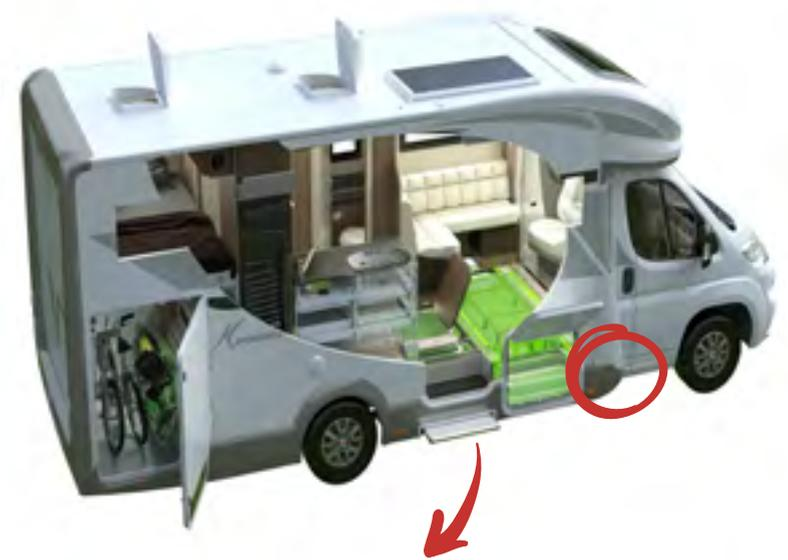
**Marche d'entrée** réalisée avec des matériaux stratifiés garantissant une meilleure continuité de l'isolation contre le froid provenant de la partie basse du véhicule.
