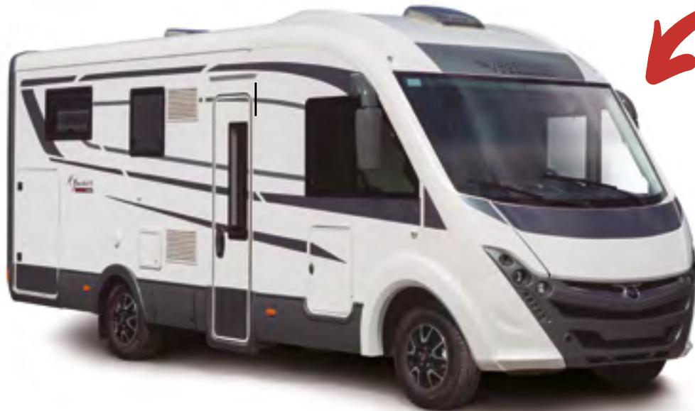
La jonction toit et parois est en profil arrondi pour une esthétique plus fluide et aérodynamique et pour offrir davantage d'isolation.
